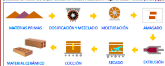
Figura 1. Proceso de obtención de material cerámico por extrusión
