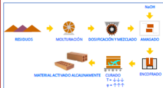
Figura 2. Proceso de obtención de material activado alcalinamente
